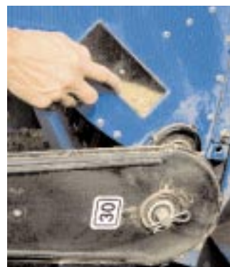
Schaufenster auf beiden Seiten des Behälters lassen den Restfüllstand sofort erkennen. Das Umstecken der Antriebskassetten beeinflusst die auszubringende Saatmenge.
