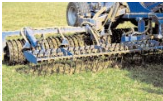
Die 101 auf dem zweireihigen Striegel angeordneten 12 mm starken Zinken sorgen für das Belüften der Grasnarbe.
