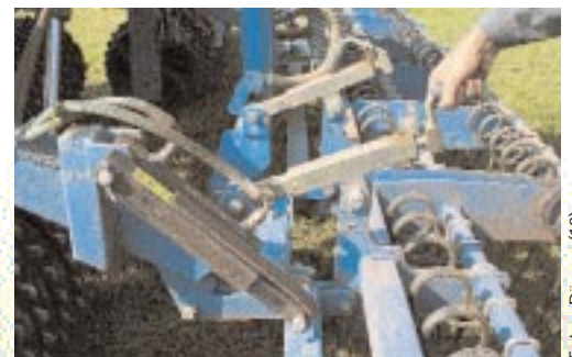
Die Striegelneigung lässt sich über die Spindeln von Hand, die Arbeitsintensität hydraulisch einstellen.
