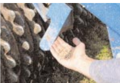
Über die sechs trichterförmigen Ausläufe wird der Samen vor der Walze kegelförmig und somit über die volle Arbeitsbreite ausgebracht.
