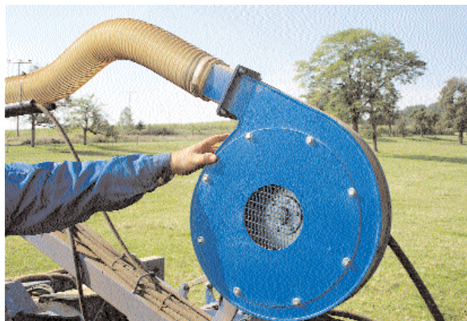
Das Gebläse wird hydraulisch angetrieben, weshalb der Traktor mit insgesamt fünf Steuergeräten oder einer Weiche ausgestattet sein muss.
